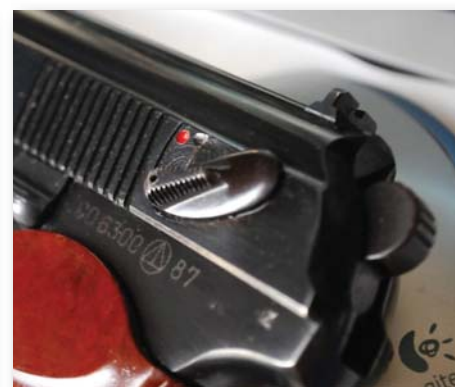
Команда кочнице на задњем делу левог бока навлаке: горе – укочено, доле – откочено
