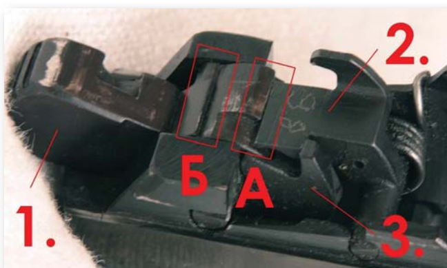
Детаљ механизма за окидање: 1. ударач, 2. запињача, 3. полулица за напињање. На ударачу се могу зајзигити два уреза: А. – онај у кога упире зуб запињаче када је ударач у задњем положају и Б. – безбедносни урез, кога запињача „лови“ својим зубом, у случају да дође до ненамерног ослобађања ударача са првог уреза
